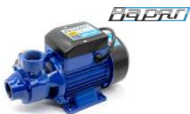
НВЧ-400 (вихревой) 400 Вт, 30 л/мин, чугун, напор 28 м, h всасывания 8 м АРТ. 0238
