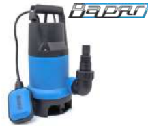
НГ-450Н Насос д/грязной воды 450 Вт, 160 л/м, h всас. 7 м, глубина вкл. 53 см / выкл. 10 см Арт. 0000159
