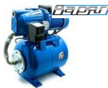
НПЧ 900 Y-24 900 Вт, чугун, 45 л/мин, напор 45 м, 24 л АРТ. 0241
