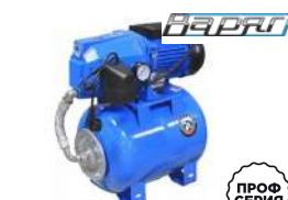
НПЧ-1300P-24 1300 Вт, чугун, 65 л/мин, напор 55 м, 24 л АРТ. 140322
