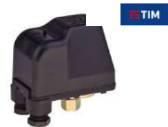
PS-02B Реле давления 1/4" накидная гайка, 2,1-3,5 бар 1500 Вт, 16 А АРТ. 003022
