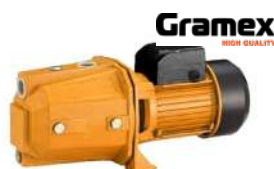
JET 80 L 800 Вт, 50 л/мин, напор 38 м, h всасывания 8 м
