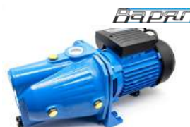
НПН - 1200 Y 1200 Вт, 60 л/мин, чугун, напор 53 м, h всасывания 8 м
