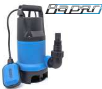
НГ-650Н Насос д/грязной воды 650 Вт, 180 л/мин, h подъема 7,5 м Арт. 0000153
