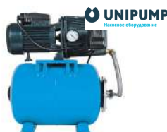
AUTO JET 100 S-50 750 Вт, 56 л/мин, 50 л, напор 43 м АРТ. 221411
