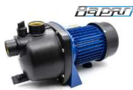
НПН-950 950 Вт, 45 л/мин, напор 40 м, h всасывания 8 м
