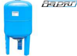
ГА 80В/1 Гидроаккумулятор 80 л, макс. давление 8 бар, d 450 мм Арт. 0064
