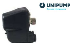
LP/3 Датчик сухого хода 16 А, 1/4 внутренняя резьба, от +1 до +40 АРТ. 21501
