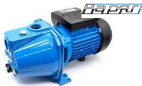
НПЧ-950 К 950 Вт, 45 л/мин, напор 43 м, чугун, h всасывания 8 м АРТ. 0237
