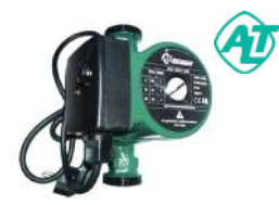
25/8-180 180 мм, напор 8 м, 145 Вт, подключение 1" APT. 000215
