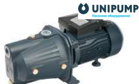
JET 100 L 750 Вт, 60 л/мин, напор 43 м, h всасывания 8 м АРТ. 216691
