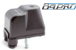
PM 5 Реле давления (п) 1/4" наружное 1500 Вт, 5 бар, 12 А АРТ. 0265
