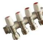
Коллектор с регулирующими вентилями под 45°, 1"г/ш x 16ц - 4 вых. MR135N-1-C-4 ТИМ АРТ. 002121
