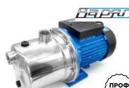
НПН-1150П 1150 Вт, 70 л/мин, напор 48 м, h всасывания 8 м
