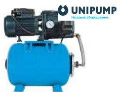
AUTO JET 100 L-50 750 Вт, 60 л/мин, напор 43 м, 50 л АРТ. 221409
