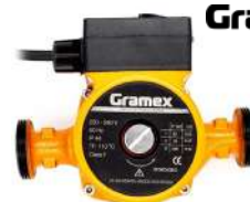
UP-32-40 180 мм, напор 4 м, 62 Вт, подключение 1 1/4" APT. 01113
