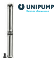
ECO MIDI-3 (центробежный) 750 Вт, напор 92 м, подключение 1 1/4"
