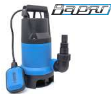
НГ-850Н Насос д/грязной воды 850 Вт, 235 л/мин, h подъема 8,5 м Арт. 0000154
