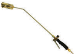
Горелка кровельная газозвдуш- ная КОРУНД ГВ-700Р, 40 кВт, про- пан-бутан, расход газа 4500 гр/ч
