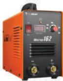
МАСТЕР 162 Инвертор сварочный 160 А, 190-235В, 1,6-5,0 мм, IP21S.
