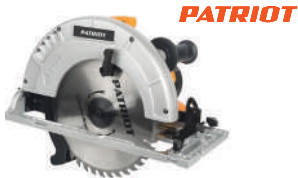
CS255 2000 Вт, 255 мм, 4000 об/мин, угол 45°.
