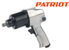
PN 610 Гайковёрт пневматический 6 бар, 610 Нм, диаметр штуцера 1/4.
