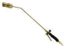
Горелка кровельная газозвдуш- ная КОРУНД ГВП-700Р, 40 кВт, пропан-бутан, расход газа 4500 гр/ч
