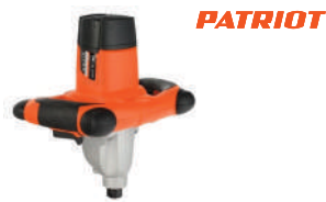
DM120 1275 Вт, ключевой патрон 16 мм (M14), 2 скорости, 0-480/0-800 об/мин.
